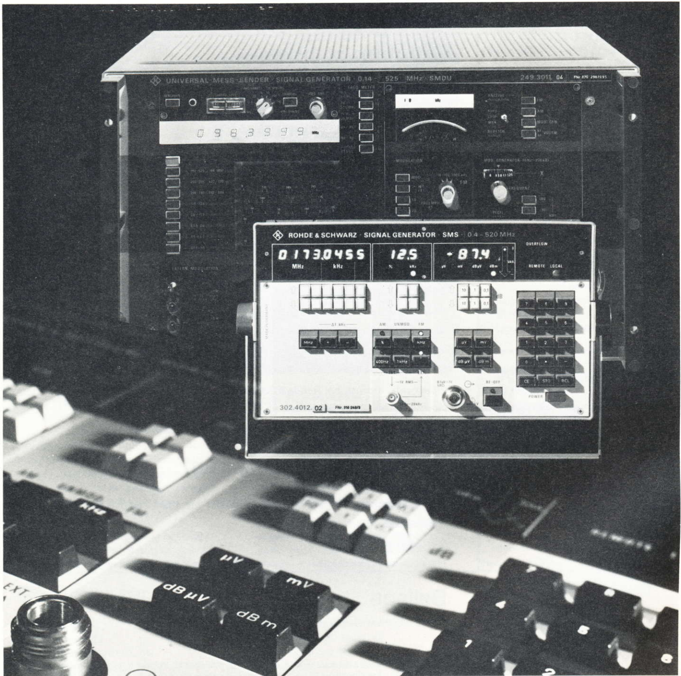
BILD 1 Programmierbarer Signalgenerator SMS für 0,4 bis 520 (1040) MHz. Im Hintergrund negativ einkopiert der Universal-Meßsender SMDU.
